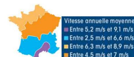
Figure 1 : l'aléa éolien en France avec ses quatre zones de vent homogènes
